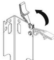
Удерживающий зажим настенного крепления был разработан для поддержки крепления радиатора к настенному креплению, снижая смещение радиатора с настенного крепления.
